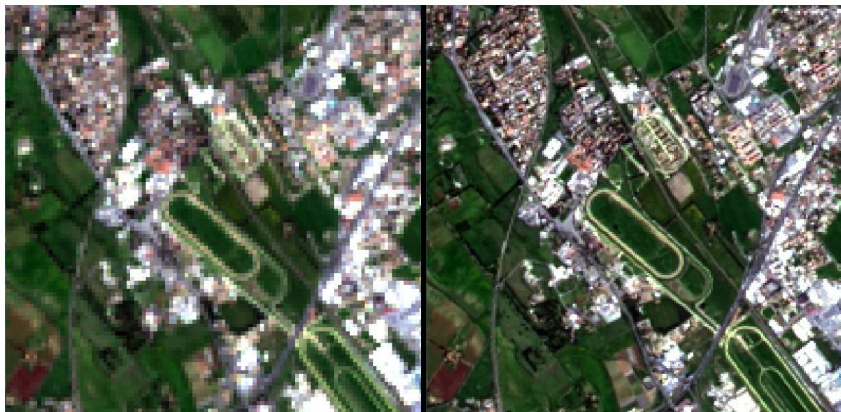
Fig. 14.4: Exemplo da fusão de uma imagem Landsat 8. À esquerda, a composição multiespectral original (30m); à direita, a imagem após a fusão (15m)
